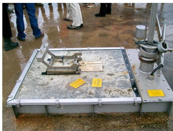
Oberried: Deckel des Gärbehälters + Einfüllrohr (re.)
