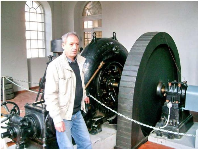
La microcentrale hydroélectrique à Mittlach/ vallée de Munster, produit de l'électricité de la rivière Fecht à la jonction Kolben-Fecht et Langenwasen dans une petite ancienne usine d'industrie textile. La microcentrale origine de 1927 et a une puissance électrique de 75 Kilowatt et produit environ 450 000 kWh par an. C'est plus que les besoins d'une commune de 320 personnes comme celle de Mittlach dans le Parc naturel régional des Ballons des Vosges.
