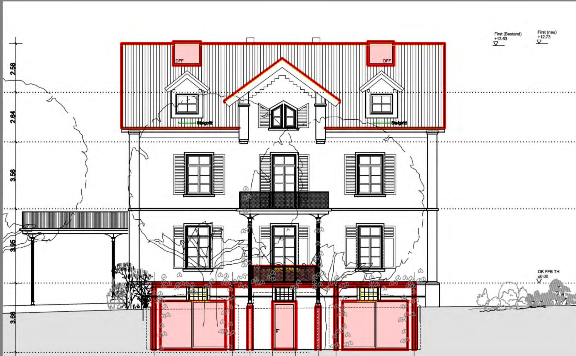
Aufstocken und Dachausbau für mehr Wohnraum
