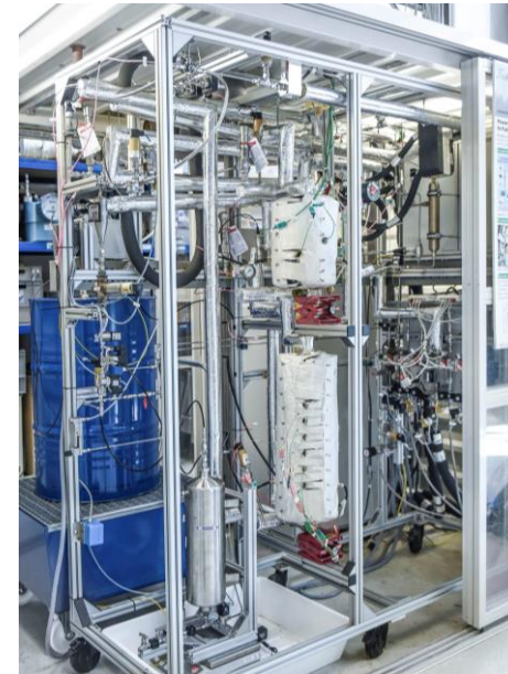
Miniplant-Anlage zur Methanolsynthese © ISE 2017
