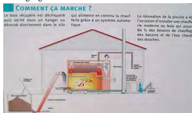
Erläuterungstafel der Hackschnitzel-Heizzentrale
