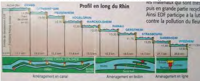
Die Kette der Wasserkraftwerke am Oberrhein Schautafeln bei den Kraftwerken Vogelgrun/Breisach und Marckolsheim
