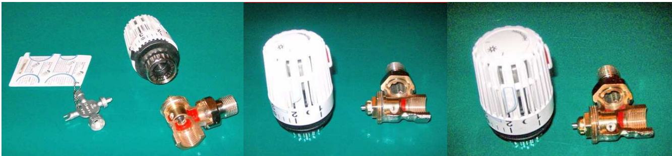
Heizkörper-Thermostatventile zum Einstellen beim hydraulischen Abgleich fürs weitere Stromsparen bei den Pumpen: Mitte und rechts: die kleine Öffnung im weißen Kreis vorderseitig am Ventil kann mittels Schlüssels (linkes Foto) auf verschiedene Weiten voreingestellt werden, so dass alle Heizkörper strömungsdynamisch gleichberechtigt sind und die elektrische Leistung der Pumpe klein gewählt werden kann
